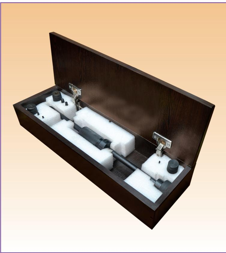
ابزار پین کش برای تسريع در خارج نمودن پین رزوه دار از سوراخ و همچنین برای شافت ها، در پوش ها و دیگر تجهیزات ماشین آلات استفاده می شود. این ابزار دارای تبدیل های قابل تعویض بیچی جهت تمامی رزوه ها از M4 الی M16 می باشد.
